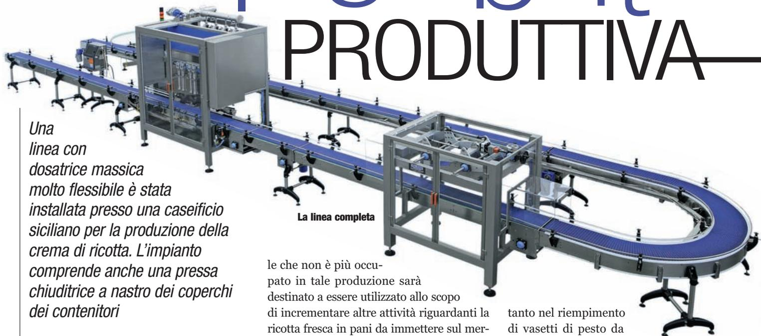
*Una linea con dosatrice massica molto flessibile è stata installata presso una caseificio siciliano per la produzione della crema di ricotta. L'impianto comprende anche una pressa chiuditrice a nastro dei coperchi dei contenitori*
