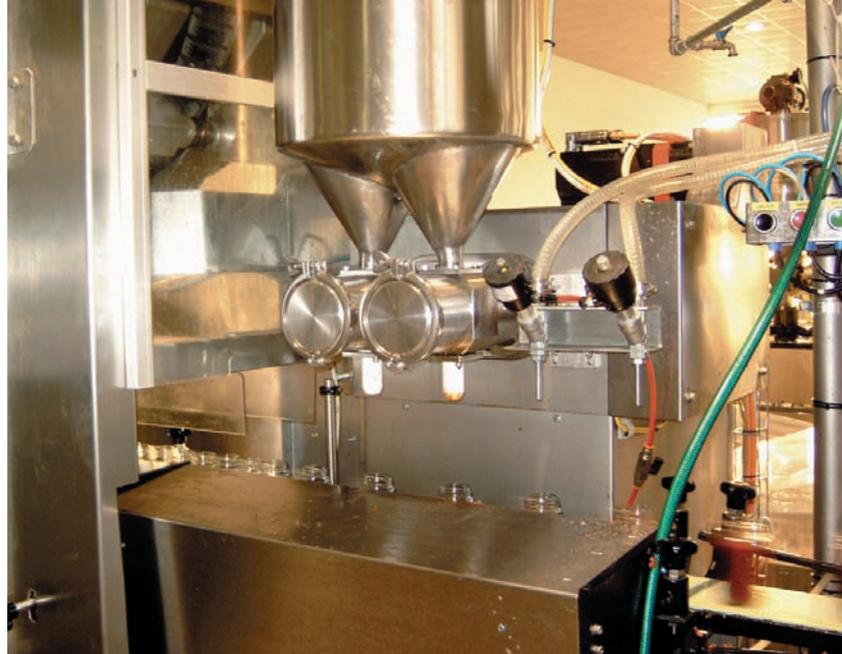
Riempimento dei vasi mediante la **dosatrice 2XP**. A sinistra i due ugelli di dosaggio del prodotto, a destra quelli di dosaggio dell'olio di rabbocco
